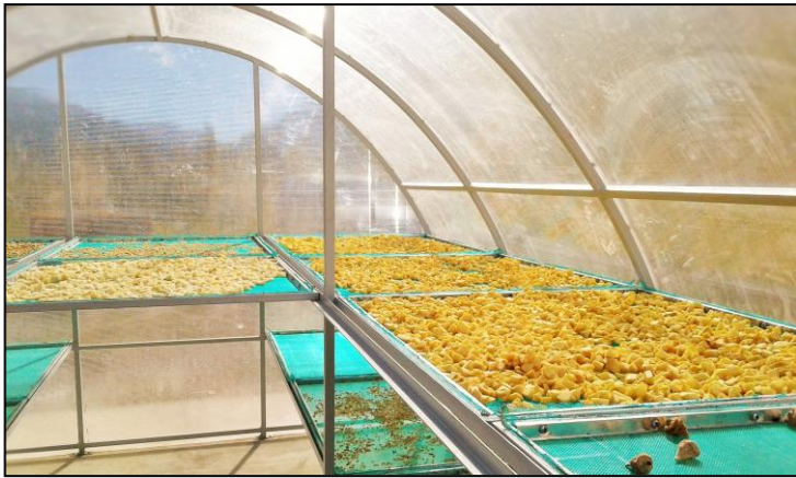
Frutas cortadas para Api y Tojorí, en proceso de deshidratación dentro del secador solar de la OECOM-SPS
